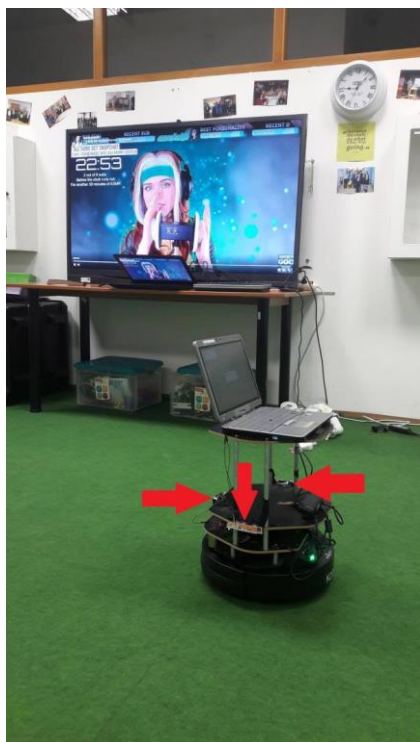
Image 5: Umiestnenie senzorov na robotovi
